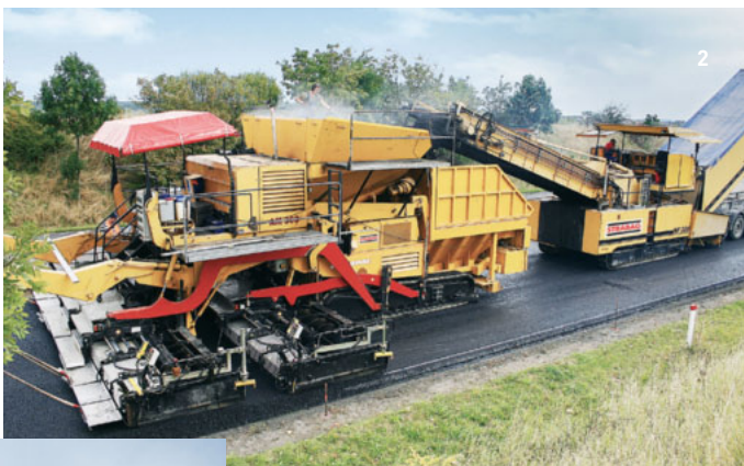
1 Aktiver PAST-Transponder vor dem Einbau / 2 Kompaktasphalt-Fertiger / 3 Innovationsfertiger / 4 Aufbringen von Titandioxid modifiziertem Splitt auf der Untersuchungsstrecke B187, Wittenberg
